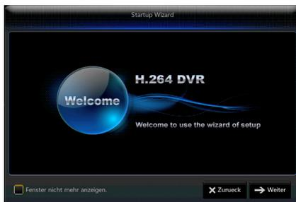
Bei der ersten Inbetriebnahme des DVR öffnet sich zunächst der Startup Wizard, ein Installationsassistent, in dem Sie erste Einstellungen vornehmen können.
