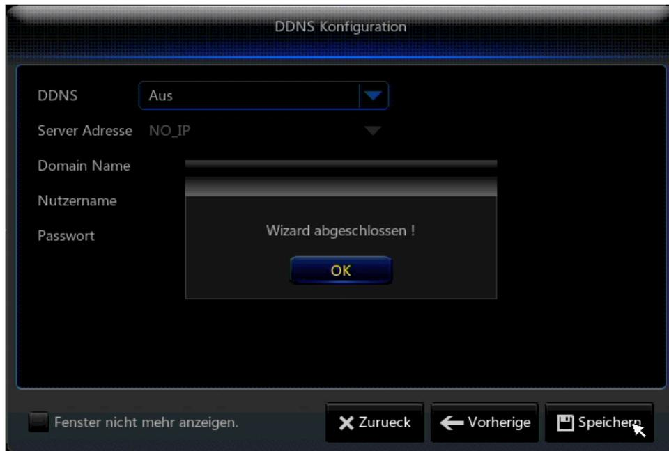
Der Recorder wird durch einen P2P Service unterstützt. Einstellungen auf dieser Seite sind nicht erforderlich.
