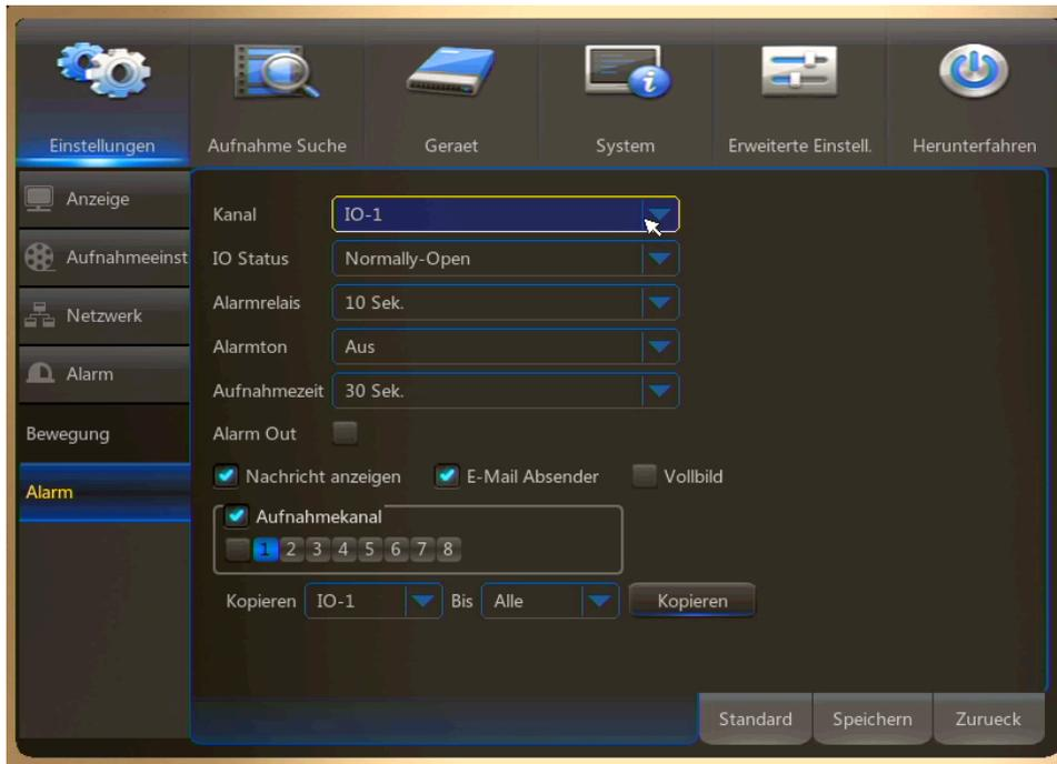
In diesem Fenster können Sie die Einstellungen der Sensoreingänge vornehmen, bei deren Aktivierung eine Aufnahme gestartet wird. Weitere Informationen zur Konfiguration der Sensoreingänge finden Sie in der Hauptanleitung, Kapitel 7.5.2.
