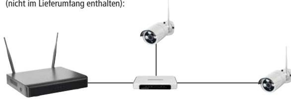
Einsatz eines WR100E (optional erhältlich) als WLAN-Access Point:
