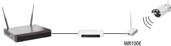
Einsatz eines WR100E (optional erhältlich) als WLAN\*\*-Repeater:
